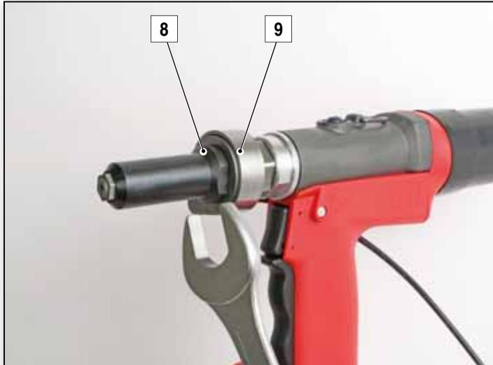
Al fine di rilevare correttamente il segnale, assicurarsi che il cannotto (8) della rivettatrice sia correttamente fissato a battuta contro il portasensore (9).
